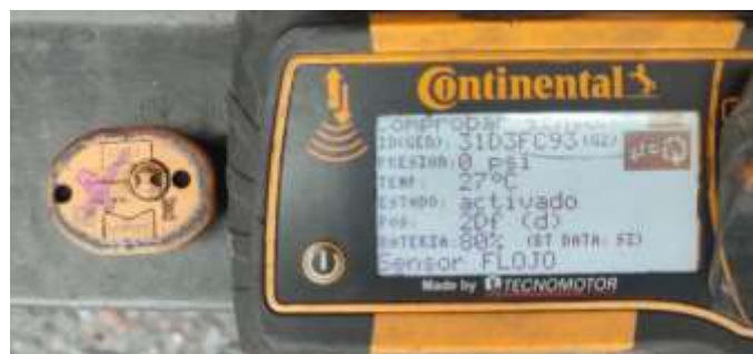
Fotografías HHT o app sensor desmontado
